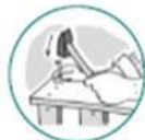
einen Nagel mit dem Hammer einschlagen
